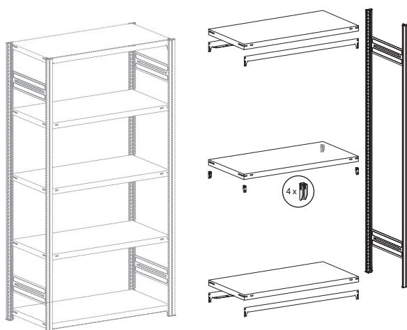
(D) An das stehende Grundregal werden die Anbauregale angefügt. Einen Stützrahmen neben das Grundregal stellen (Abb. 13). Zwei Aussteifungstraversen in die unterste mögliche Einhängeposition einhängen und mit Sicherungsstiften sichern (Abb. 11).
